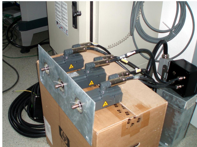
Abbildung 6.14: Versuchsaufbau mit drei Motoren. Die SPS-Simulation kann den NC-Kern zur Ansteuerung der Antriebe über MoveAbsolute nicht simulieren, hier muss direkt auf dem Kuka-Rechner getestet werden
