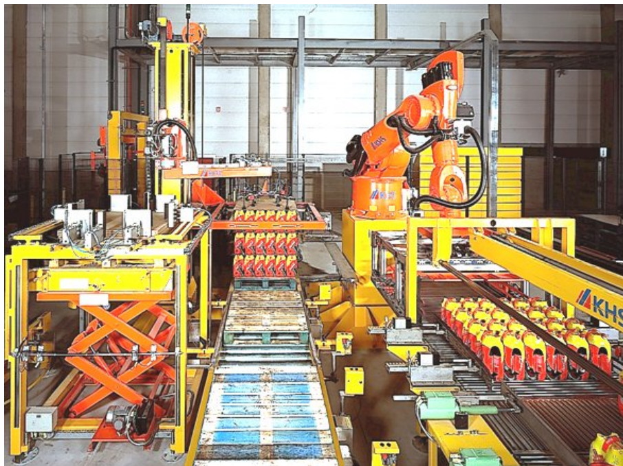
Abbildung 2.32: Beladermodul bestehend aus Zentrierer und Zwischenlängen-Einleger als externe Servoachsen an der Hubstütze (links) und Kuka-Knickarmroboter (rechts). Betrieb über eine gemeinsame Kuka-Steuerung, aus [Kuka 07b] Rau S. 9
