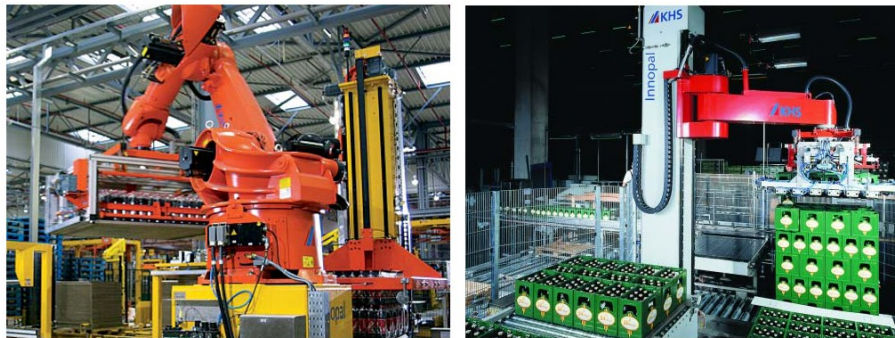
Abbildung 2.9: Palettieren von Kästen und Gebinden mit einem Kniearmroboter Innopal RK mit Rollent Teppich und Säulenzentrierung Innopal RSZ und Palettierung mit einem Säulenroboter Innopal RS, aus [KHS 07a] Innopal S. 18, Innopack S. 5
