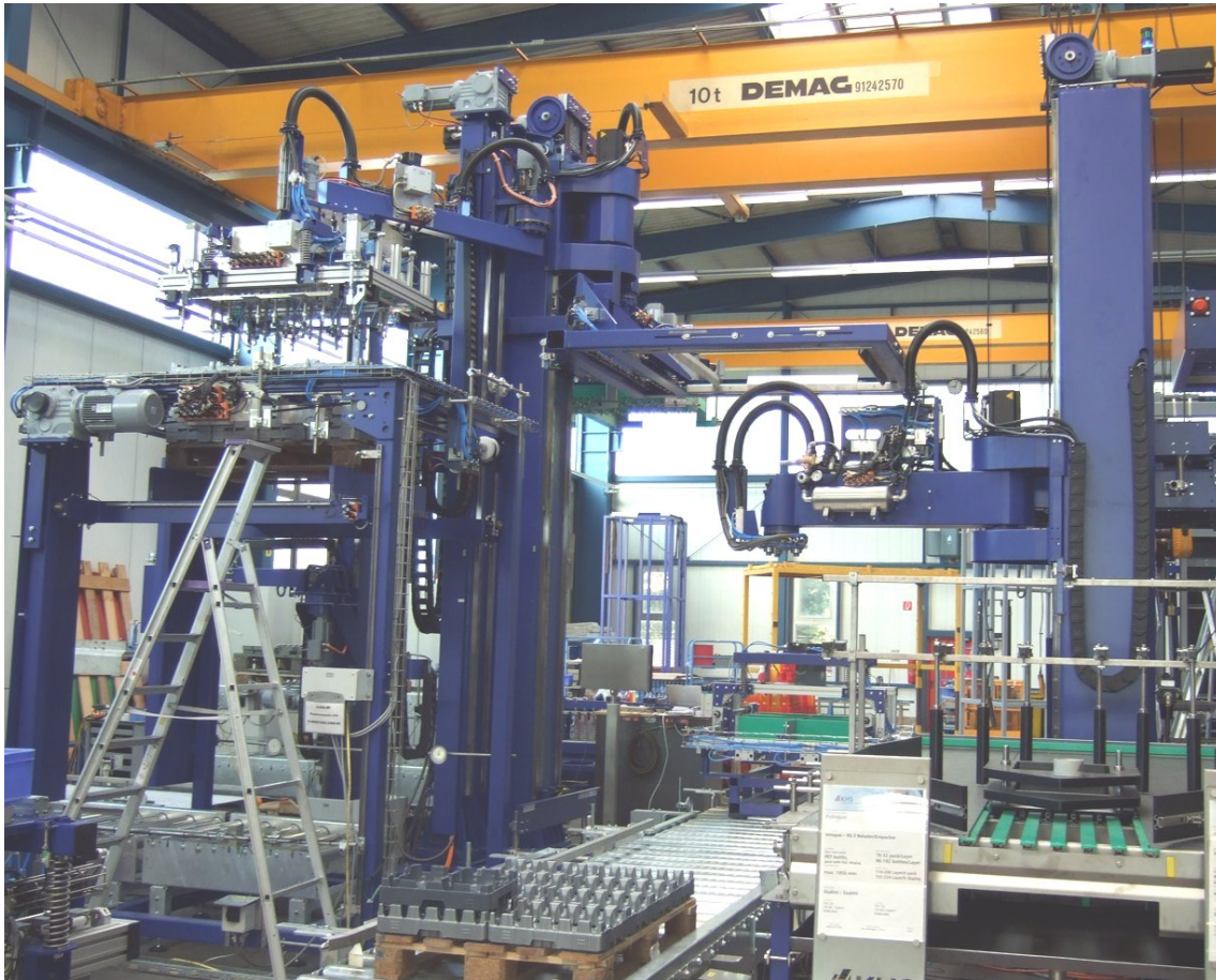
Abbildung 2.16: Robotermodul aus Abbildung 2.14 während der Produktion, nur 3 der 5 Säulenroboter sind in dieser Perspektive sichtbar, Betrieb der kompletten Anlage mit einer gemeinsamen Kuka-Steuerung
