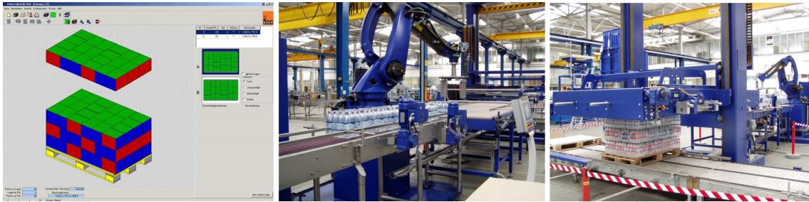
Abbildung 2.29: Werkzeug für die automatisierte Lagenbildung (links), Umsetzung der Lagenbilder durch eine Robotergruppierung mit Knickarmroboter (mitte) und gemischtes Lagenbild auf der Palette (rechts), aus [Kuka 07b] Rau S. 34, 45, 46
